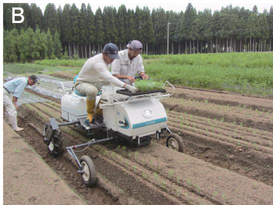
図1 タマネギ用移植機 KP2-TE (A)を用いたスギ苗の植え付け作業(B)
